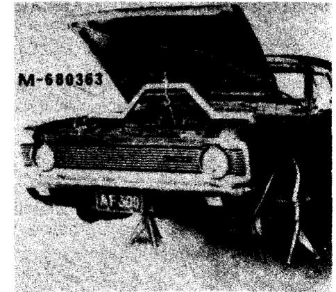
**Fig. 59-E - Motor L-4 suspenso com a ferramenta M-680363**
