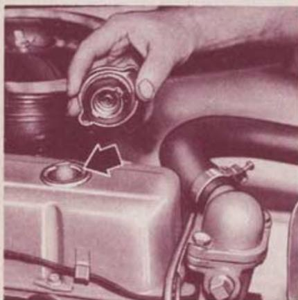
Para abastecer o cárter, remova a tampa situada na parte superior do motor e despeje o óleo especificado.
