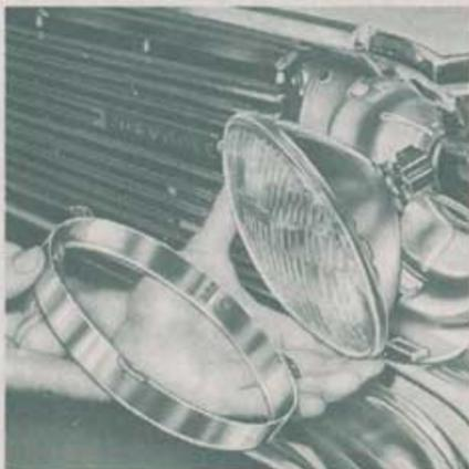
1 — Remova os parafusos de fixação do aro e remova êste.
